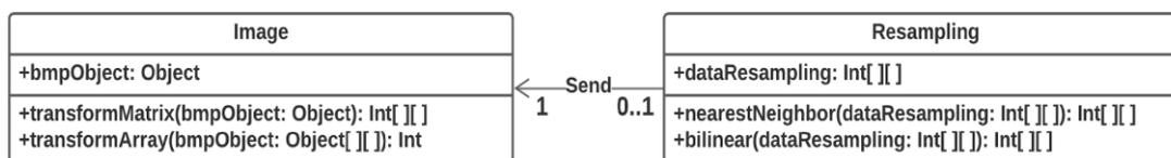
Por meio do diagrama na Figura 24, é possível compreender de forma lógica como as funcionalidades de reamostragem são integradas à classe "Image" através da classe "Resampling".
