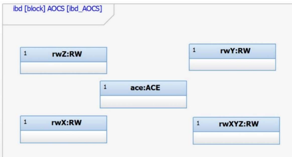
Figura 3 - IBD simplificado de um subsistema do satélite
