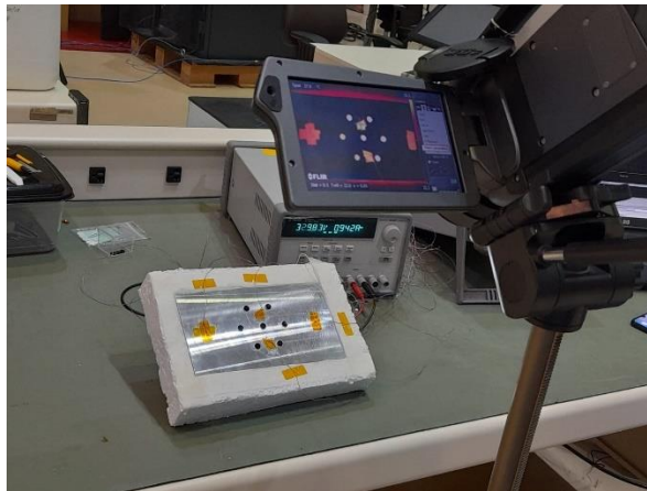
Figura 10- Ensaio termográfico com as amostras de Alumínio 6061
