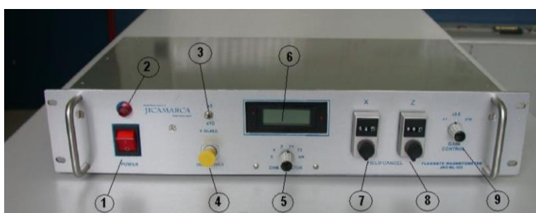
Figura 3.2: Foto da vista frontal da unidade de controle e aquisição de dados do magnetômetro.
