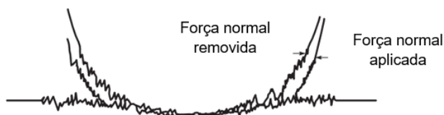
Figura 2.10 – Desenho esquemático do contato entre uma esfera em uma superfície nominalmente plana com a aplicação de uma força normal e a remoção da força.
