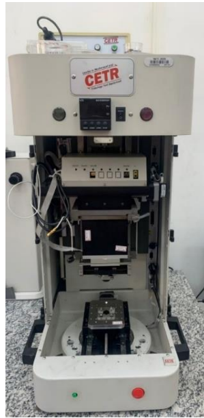
Figura 3.8 - Tribômetro linear recíproco UMT-2VAC da CETR.
