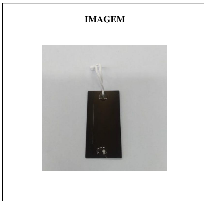
Figura 31 - Defeito intencionalmente provocado na superfície anodizada e colorida.
