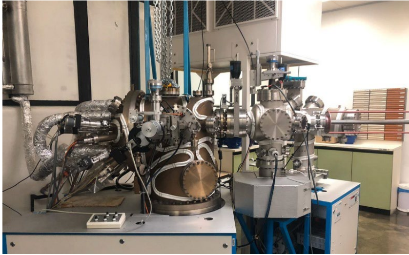
Figura 3.3 – Equipamento MBE Riber, modelo 32P, localizado nas instalações do Grupo de Pesquisa e Desenvolvimento em Materiais e Plasma no INPE.
