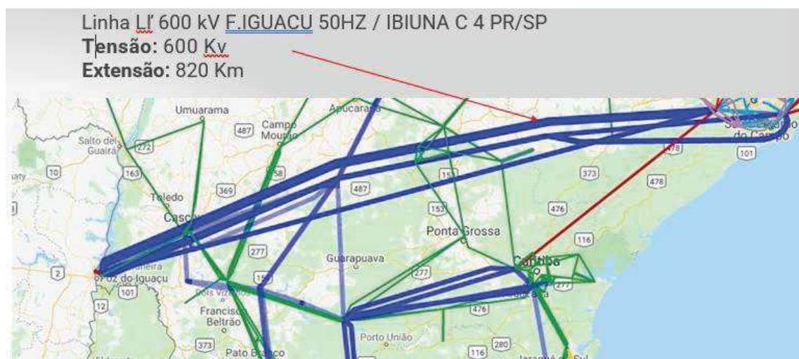
Figura 6 – Linhas de Transmissão de Alta Tensão
