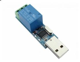
Figura 2.7 – Módulo relé com conversor CH340.
