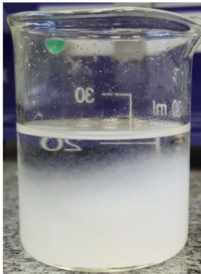
Figura 5.3 - Precipitado após ser submetido a energia ultrassônica direta.
