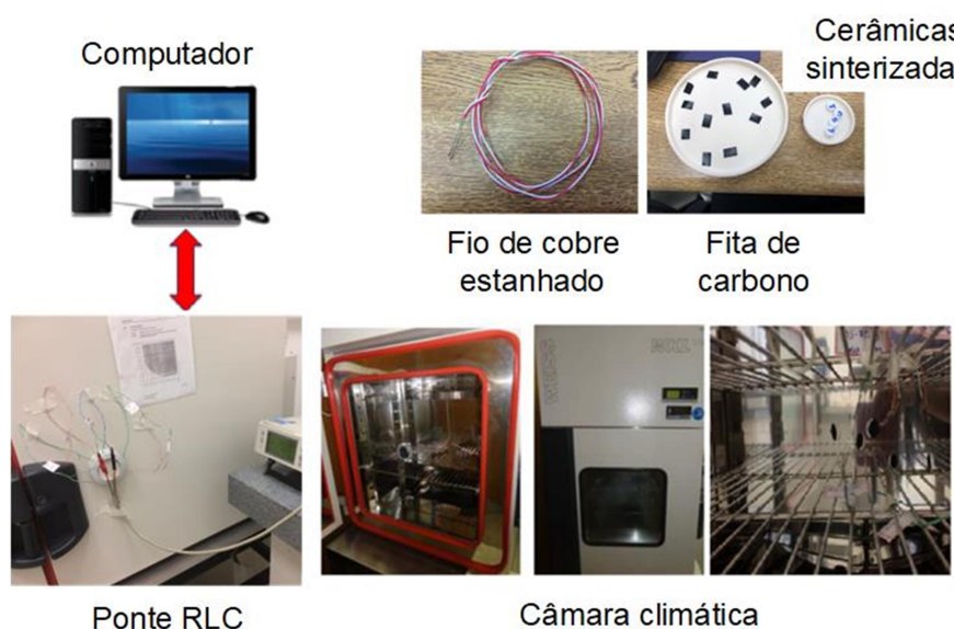
Figura 3.7 – Equipamentos e materiais para a caracterização elétrica do sensor.
