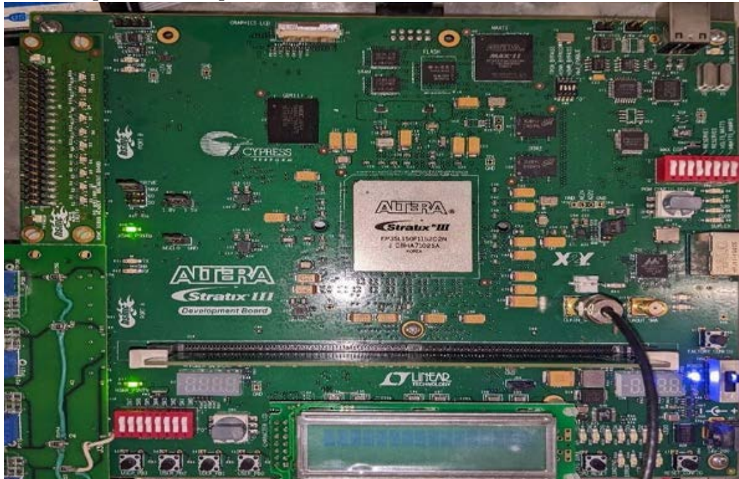
Figura 3.4 - Imagem do FPGA utilizado no correlacionador do BDA
