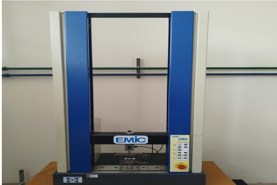
Figura 3.12 - Máquina Universal de Ensaio EMIC.
