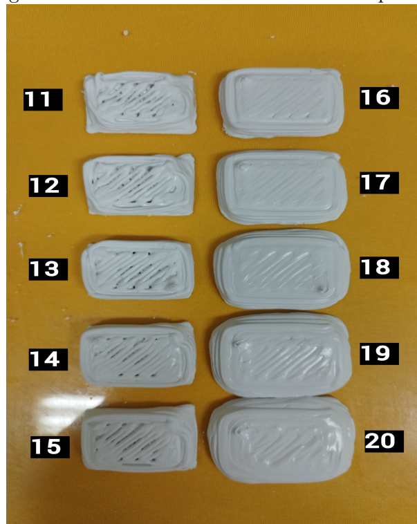
Figura 4.2 - Teste de diferentes fluxos de impressão.
