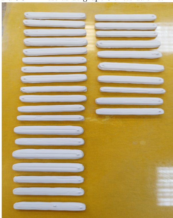
Figura 3.9 - Amostras do grupo 6 antes da sinterização.
