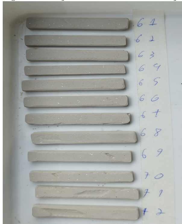
Figura 3.5 - Peças 61 a 72 antes da sinterização.
