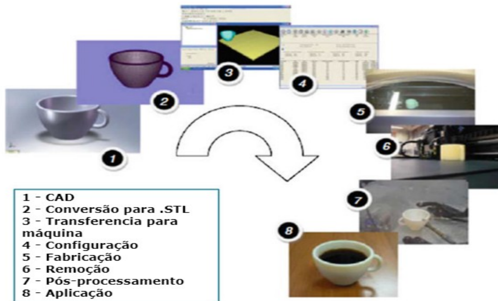
Figura 2.1 - Etapas características do processo MA.
