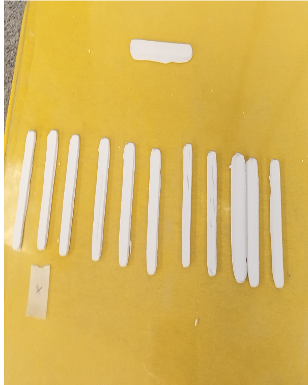
Figura 3.8 - Amostras do grupo 4 antes da sinterização.
