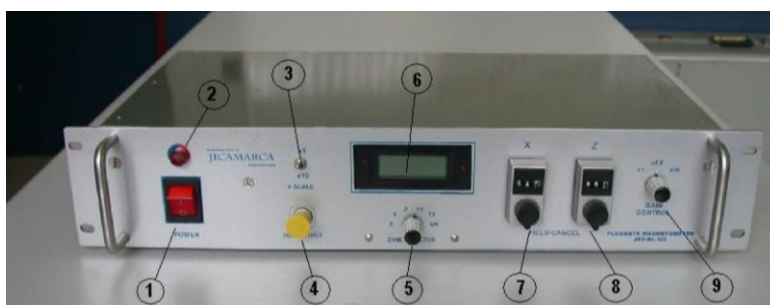
Figura 3.2: Foto da vista frontal da unidade de controle e aquisição de dados do magnetômetro.
