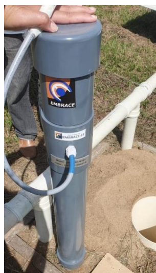
Figura 3.4: Foto do módulo do sensor de um magnetômetro da rede EMBRACE MagNet.
