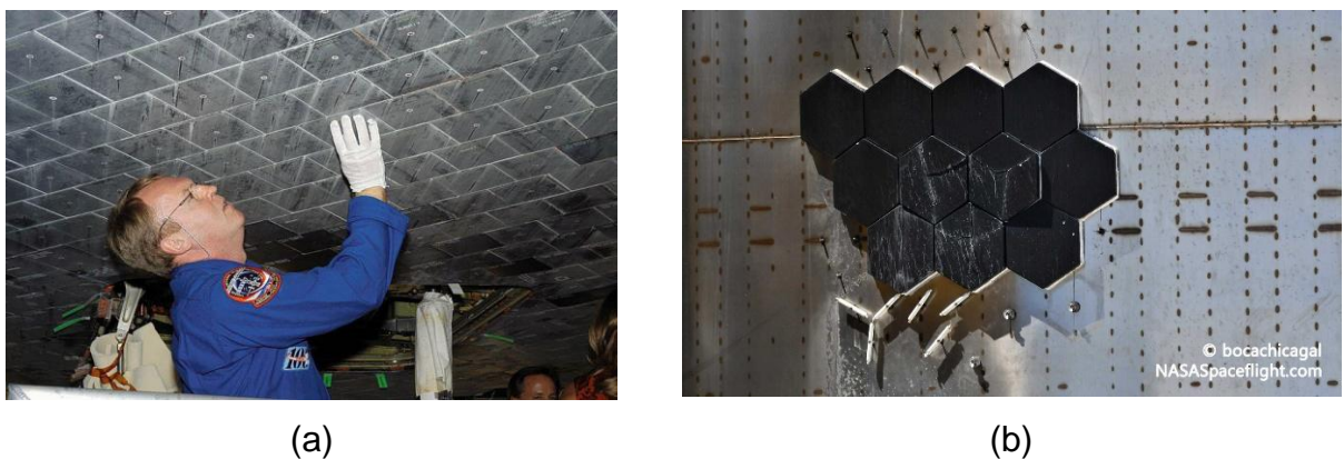
Figura 3.7 – Blindagem contra altas temperaturas.
