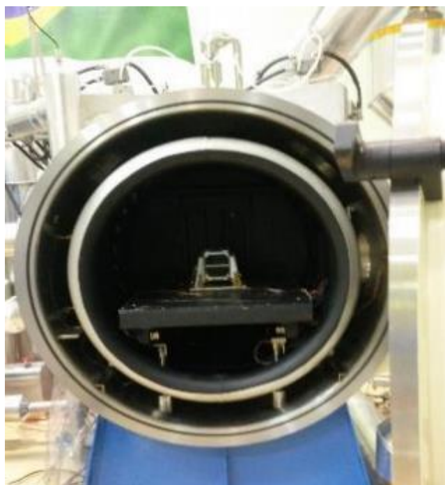
Figura 2.4. – Câmara de termovácuo do LIT/INPE com o CubeSat NANOSATC-BR1.
