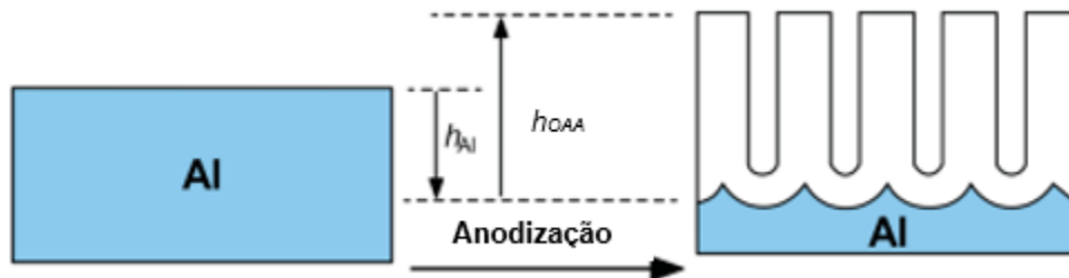
Figura 2.6 – Desenho esquemático da expansão do volume durante a anodização do alumínio.
