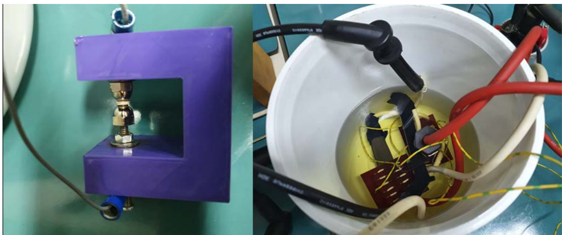
Figura 7.10 - (a) porta amostras (b) recipiente contendo óleo de transformador.
