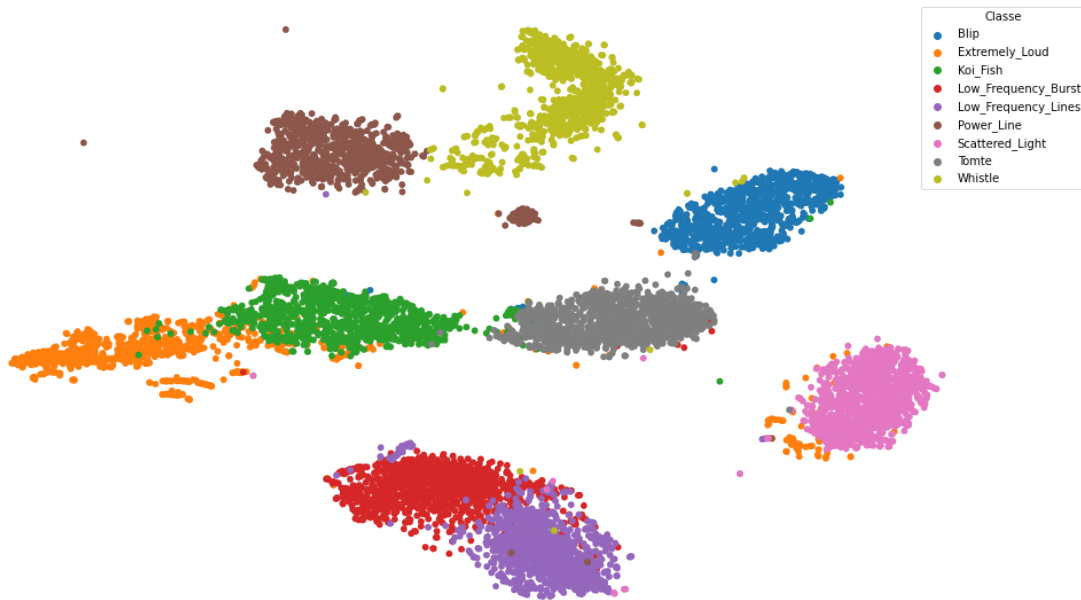
Figura 6.4 - Resposta do t-SNE (em 2D) para a análise dos nove mil glitchgramas de 1200 dimensões cada. O ponto representa um glitch e a cor, a classe. As cores foram aplicadas depois do algoritmo encontrar os grupos para conferir se eles foram bem determinados e alocados pelo método.
