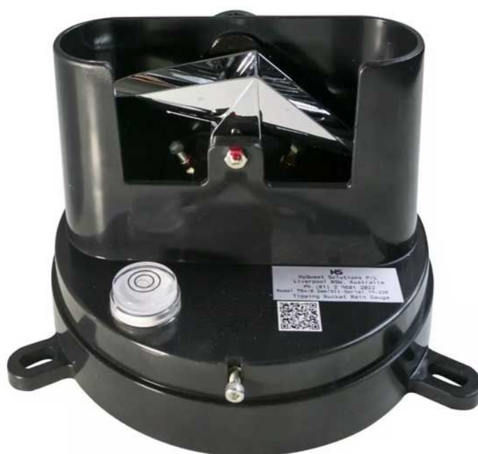
Figura 2.7 - Mecanismo basculante do pluviômetro
