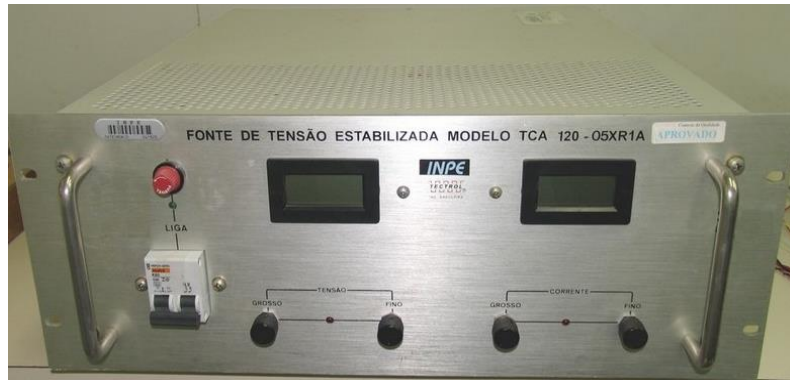
Figura 5. Fonte DC TECTROL TCA 120. Instalada no Abrigo e que irá fornecer potência para o aquecimento do Forno
