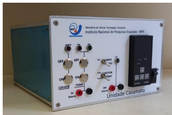
Figura 7. Unidade Casamata, principal equipamento de controle de potência e de temperatura do experimento. Possui uma chave para inibir o sinal de \mu\text{g} antes do lançamento
