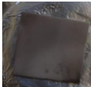
Figura 4.9 – Amostra utilizando o método de deposição do catalisador Sputtering (1 minuto de deposição).
