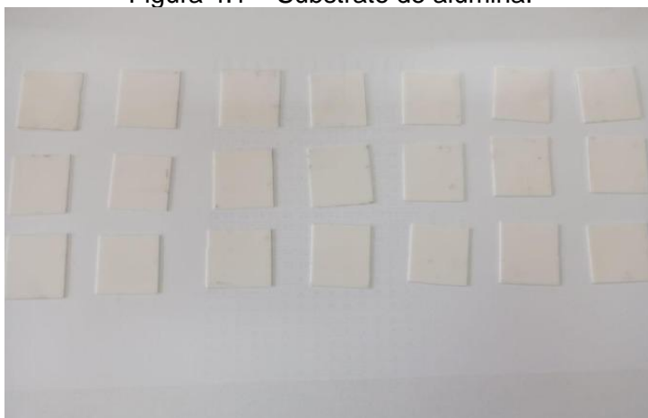
Figura 4.1 – Substrato de alumina.
