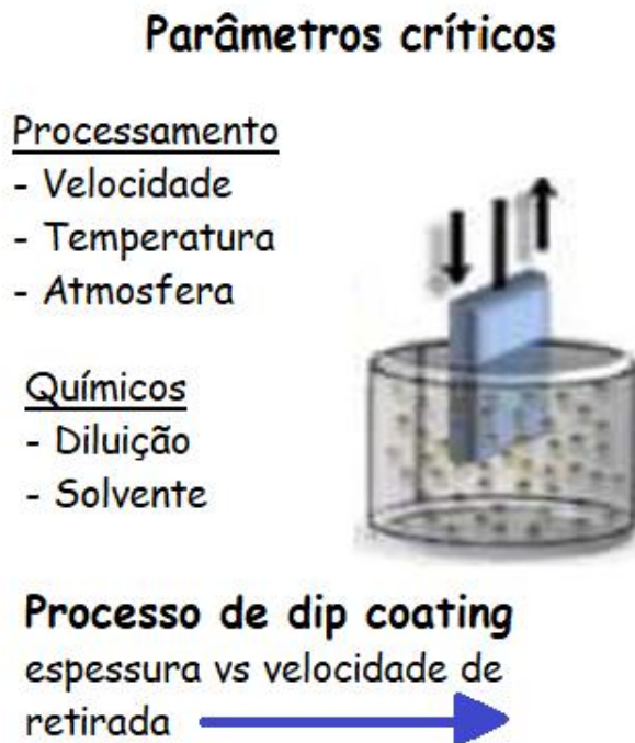
Figura 2.3 – Esquema ilustrativo dos parâmetros críticos do processo de dip coating .
