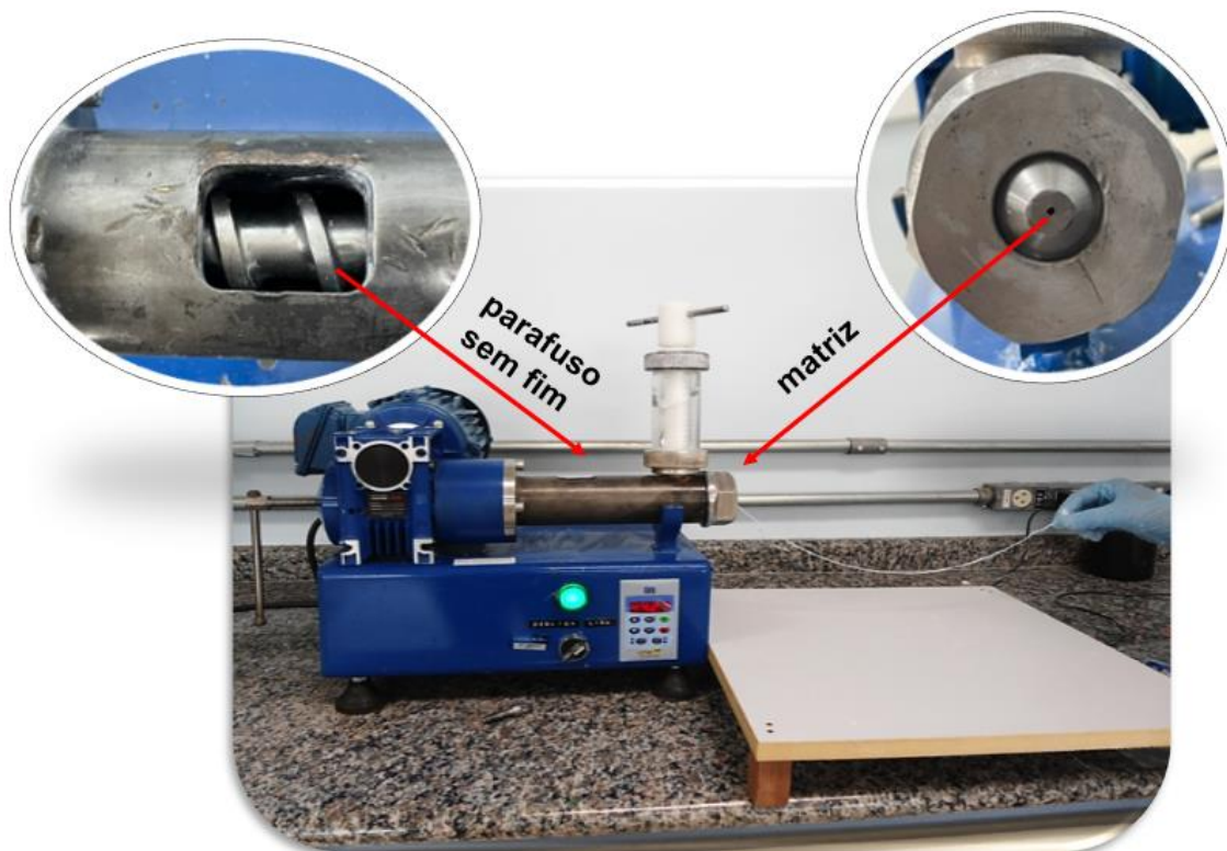
Figura 3.6 – Extrusora automática de bancada empregada na moldagem do precursor da alumina.
