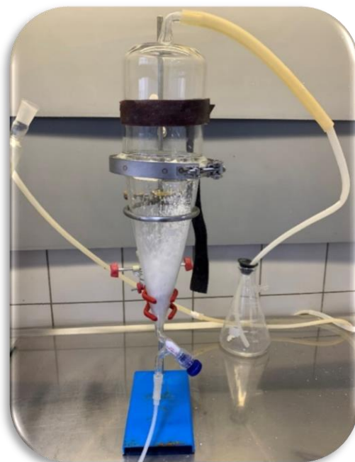
Figura 3.8 – Dispositivo empregado na esferoidização do hidróxido de alumínio e da alumina calcinada.
