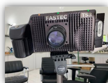
Figura 3.15 – Sistema montado para a realização dos testes com a câmera fotográfica de alta velocidade.
