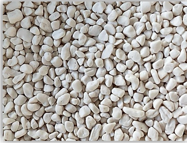
Figura 4.13 – A Alumina contendo Si calcinada a 600°C após 182 h no fluidizador.
