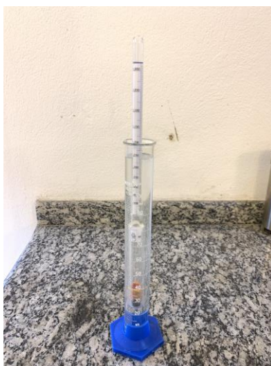
Figura 3.27 – Determinação da concentração do peróxido de hidrogênio.
