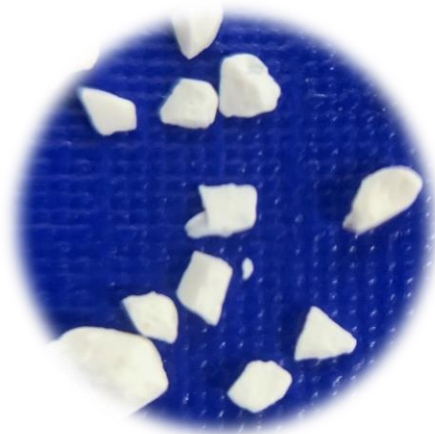
Figura 4.14 – Hidróxido de alumínio com o aditivo B seco a 120°C após 182 h no fluidizador.
