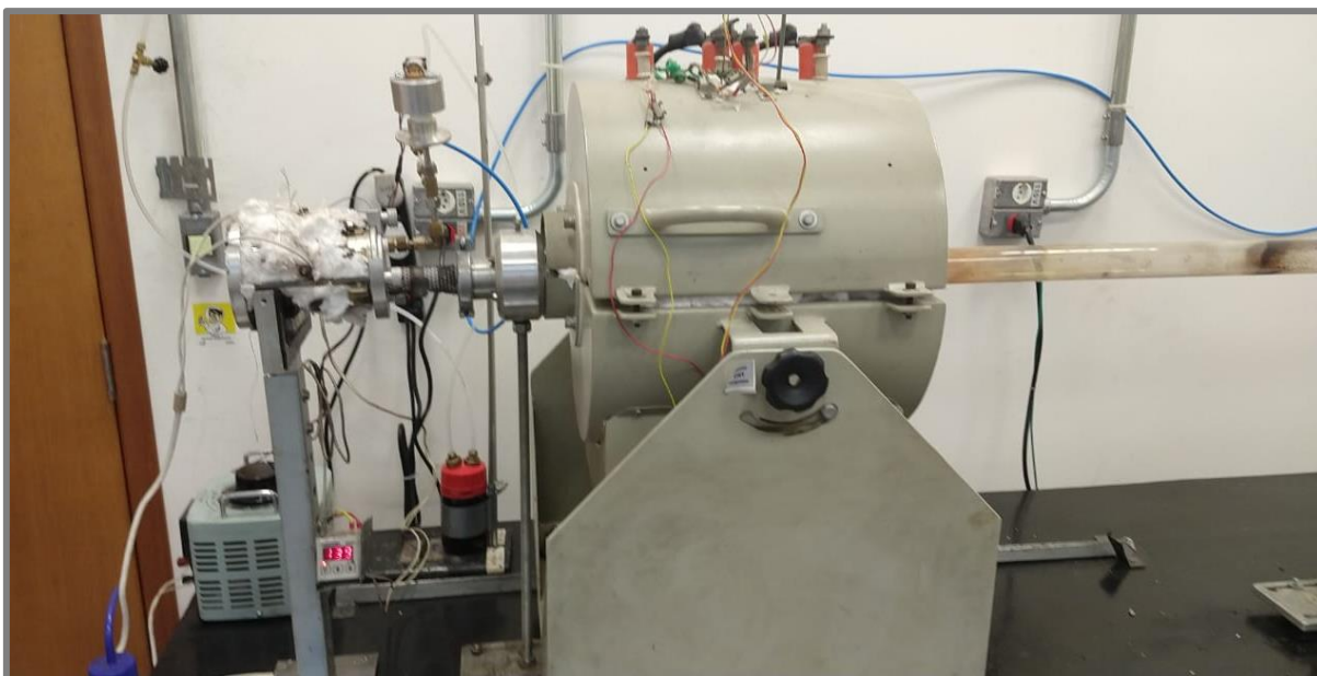
Figura 3.2 – Reator CVD térmico utilizado para a produção do compósito CNT/CF.
