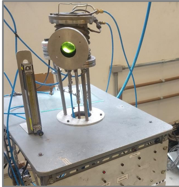
Figura 3.3 – Reator CVD de filamento quente.
