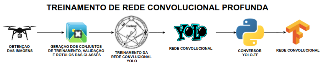
Figura 4.2 - Fluxo de treinamento das redes convolucionais.
