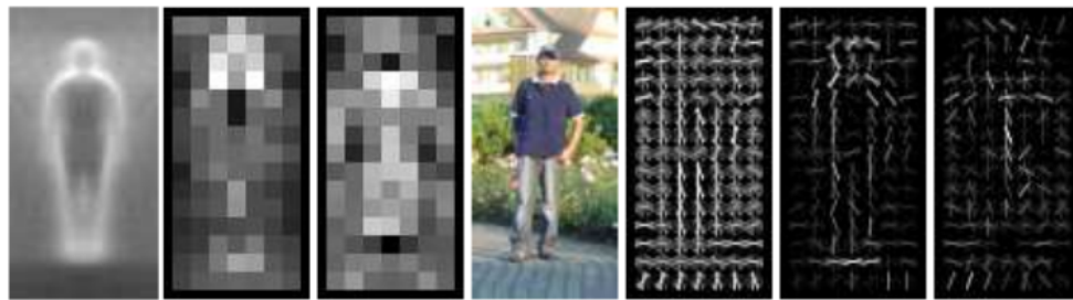
Figura C.2 - Histogramas de gradientes orientados para detecção de pessoas.
