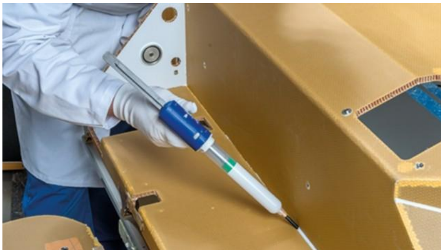
Figura 3.2 – Processos de união móvel por colagem com adesivos na indústria aeronáutica.
