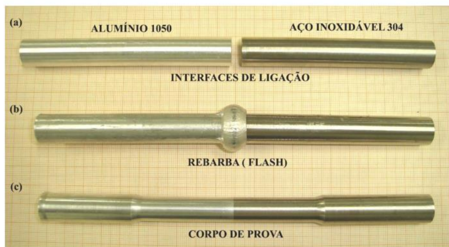
Figura 4.3 - Evolução da transformação dos pinos até a usinagem do corpo de prova.
