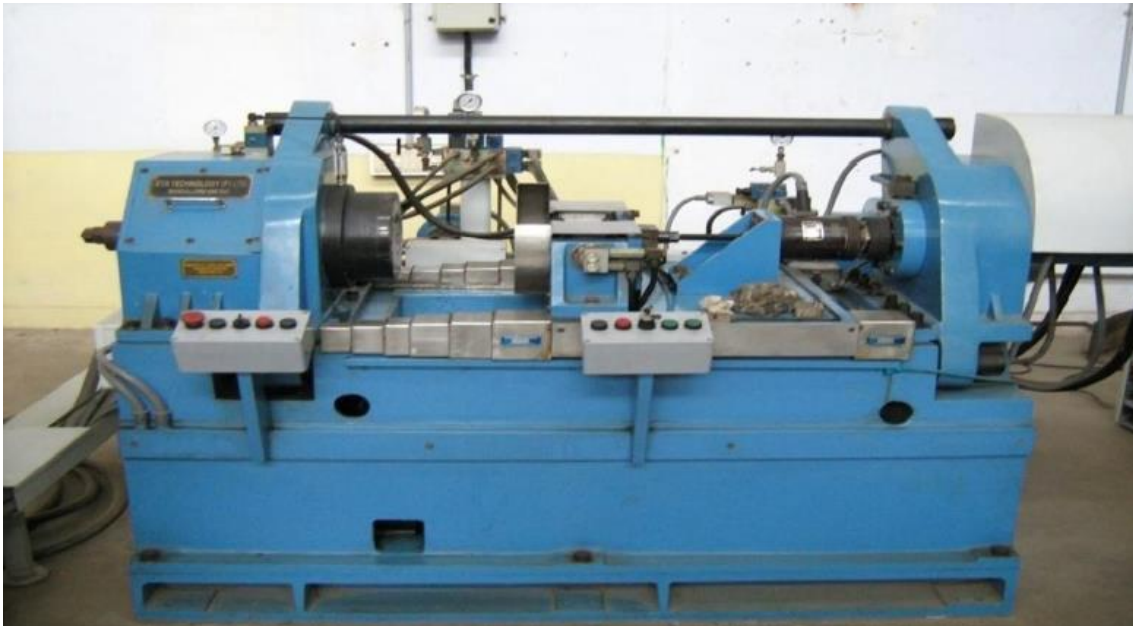
Figura 3.13 – Equipamento de soldagem por fricção rotativa.
