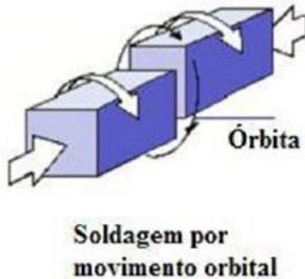
Figura 3.29 – Processo de soldagem por fricção orbital.
