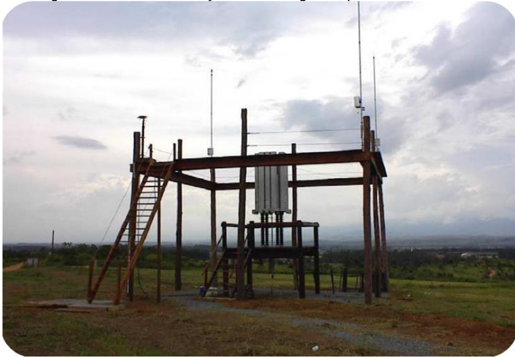
Figura 4.30 – Base de lançamento de foguetes para raios induzidos.
