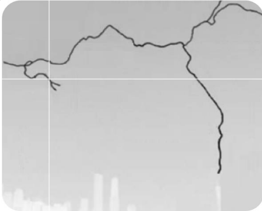
Figura 2.32 – Raio ascendente iniciado na torre de Cantão, na China.
