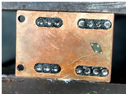
Figura 5.7 – Porta amostras do sistema de medição de resistividade e efeito Hall.
