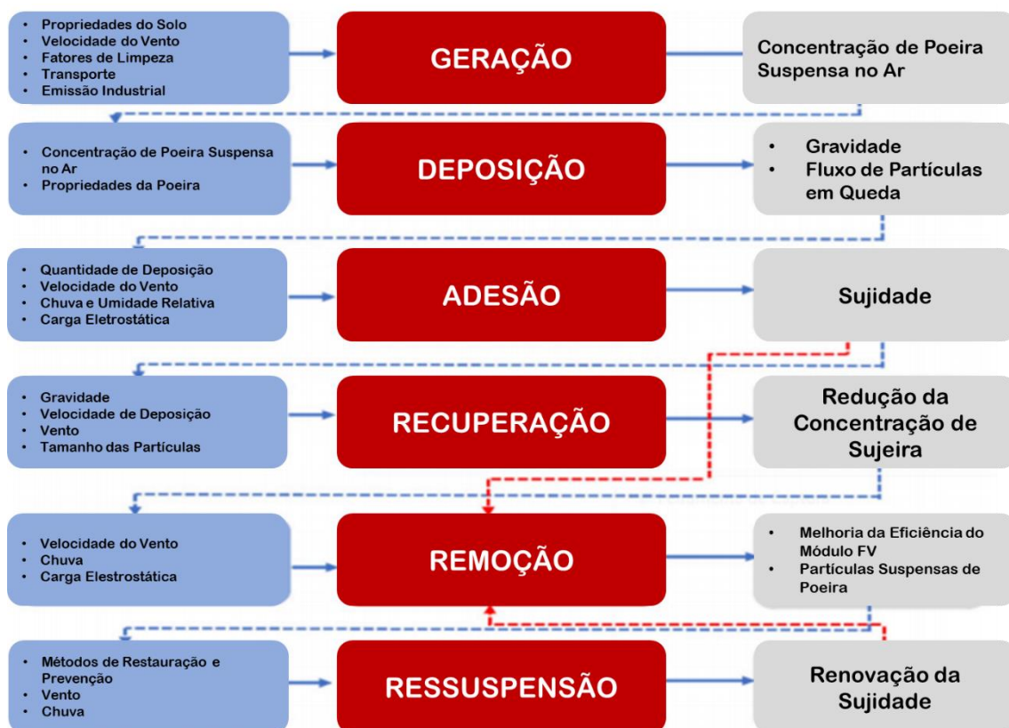
Figura 2.17 - Mecânica e fases da sujeira.
