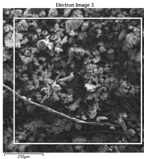
Figura 4.9 - Sujidade INPE: MEV (300x).
