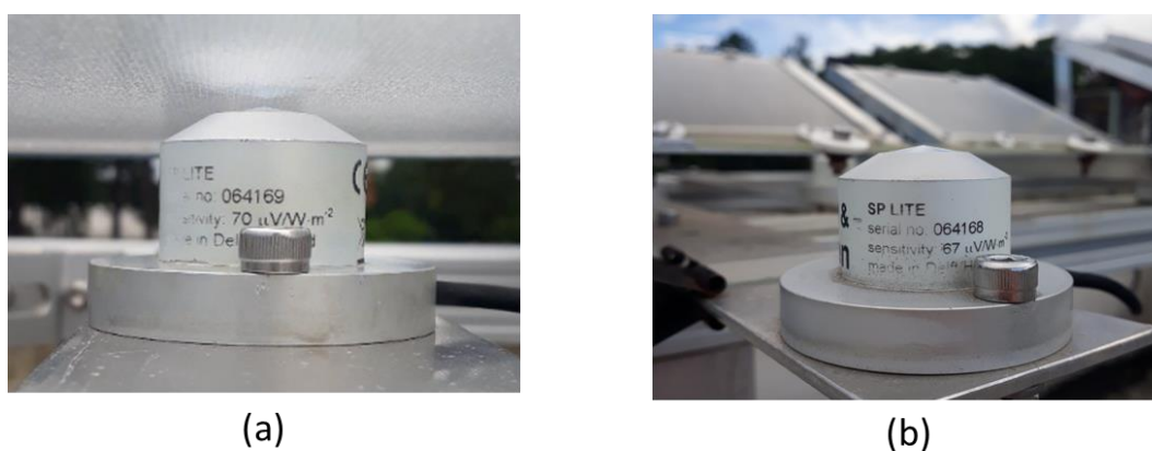
Figura 3.7 – Modelo dos radiômetros utilizados: (a) embaixo do vidro fotovoltaico; e (b) fora do vidro fotovoltaico (referência).
