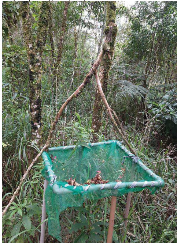
Figura 19 - Galho no coletor de serrapilheira na área em regeneração inicial ocupada anteriormente por pastagem (RP).
