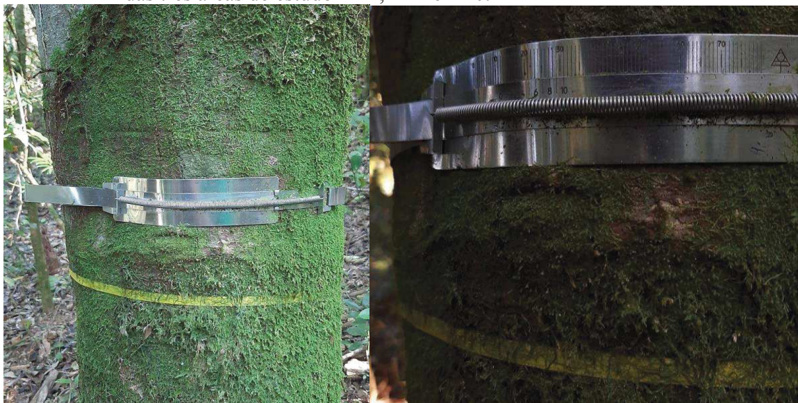
Figura 4 — Dendrômetros de fita, modelo EMS-DB20, instalados em 30/05/2019 em cada uma das três áreas de estudo - RP, R12 e R40.
