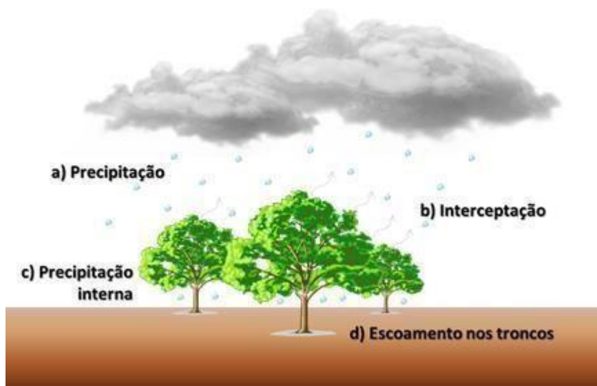
Figura 1 - Esquema da partição da precipitação em interceptação, precipitação interna e escoamento pelos troncos.
