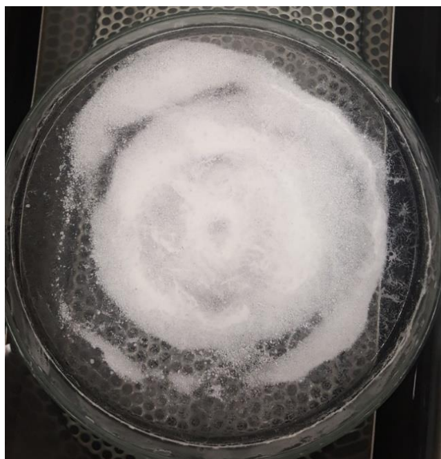
Figura 5.4 - Processo de secagem do pó em banho de ultrassom.
