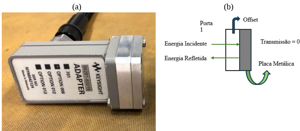
Figura 05 - (a) Configuração do ensaio de refletividade, (b) Representação do ensaio de RL.
