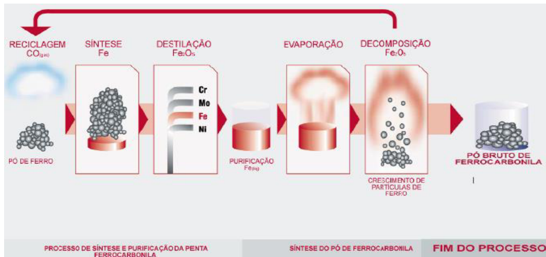
Figura 4 - Processo de purificação da Ferro-pentacarbonila.
