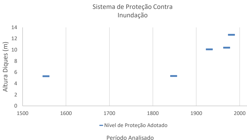
Figura 4.28: Níveis de proteção contra inundações adotado.
