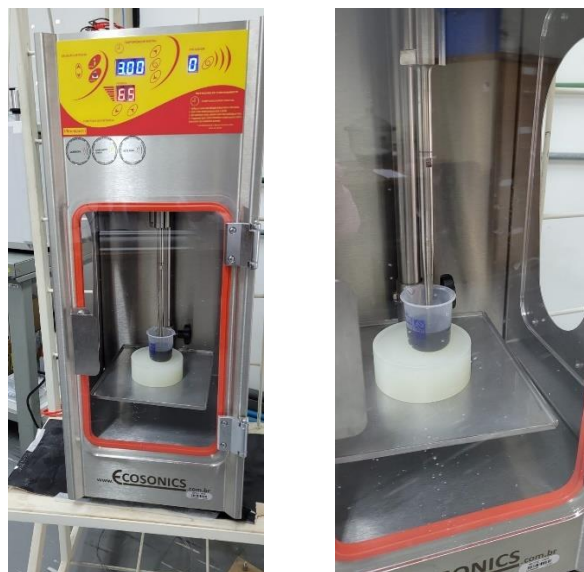
Figura 3.8 - Imagem da síntese de dispersão do óxido de grafeno em água deionizada.
