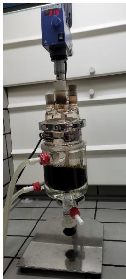
Figura 3.6 - Síntese do GO em reator químico de vidro encamisado.
