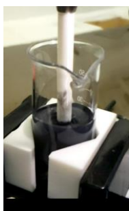
Figura 3.11 - Preparo do compósito XC em matriz polimérica usando misturador mecânico.
