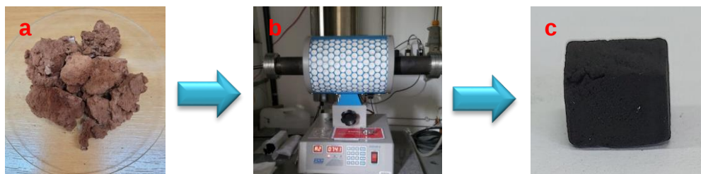
Figura 3.3 - Xerogel orgânico de tanino (a), processo de pirólise do xerogel (b), xerogel de carbono (c).
