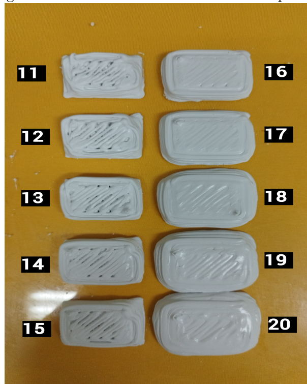
Figura 4.2 - Teste de diferentes fluxos de impressão.
