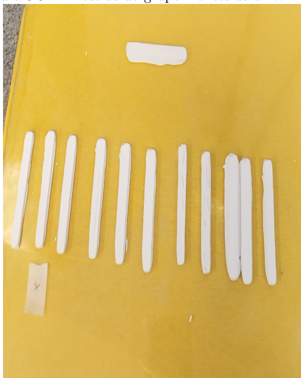
Figura 3.8 - Amostras do grupo 4 antes da sinterização.
