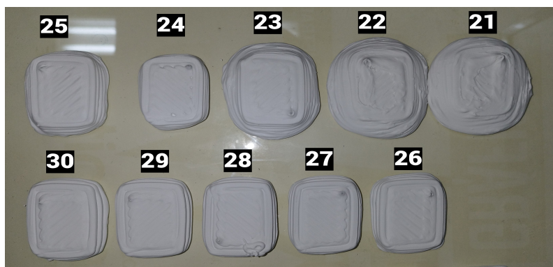
Figura 4.3 - Teste de diferentes alturas de camada de impressão.
