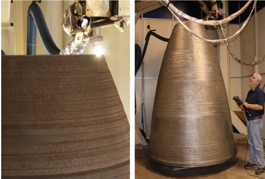
Figura 2.13 - Exemplo de tubeira fabricada por MA.
