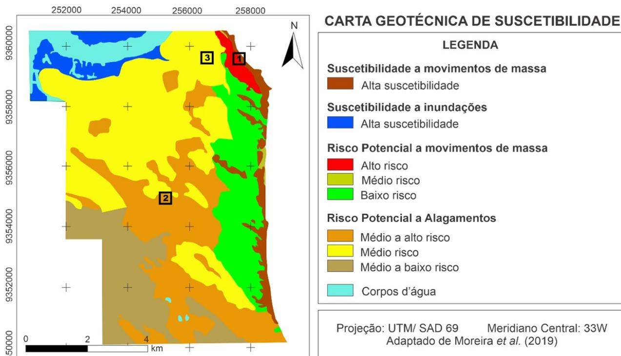
Figura 6. Carta Geotécnica de Suscetibilidade e Risco Potencial a Deslizamentos, Inundações e Alagamentos. Notar Área 1, que corresponde à localização das Figuras 7a/7b, área 2, que corresponde à localização da Figura 7c e área 3, que corresponde à localização da Figura 7d.
