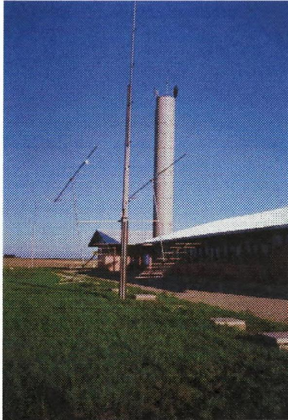
**Figura 17.** *H* instalado ao lado do Prédio 2 do Observatório Espacial do Sul – OES/CRSPE/INPE – UFSM, para testes e casamento de impedância entre as Antenas.
