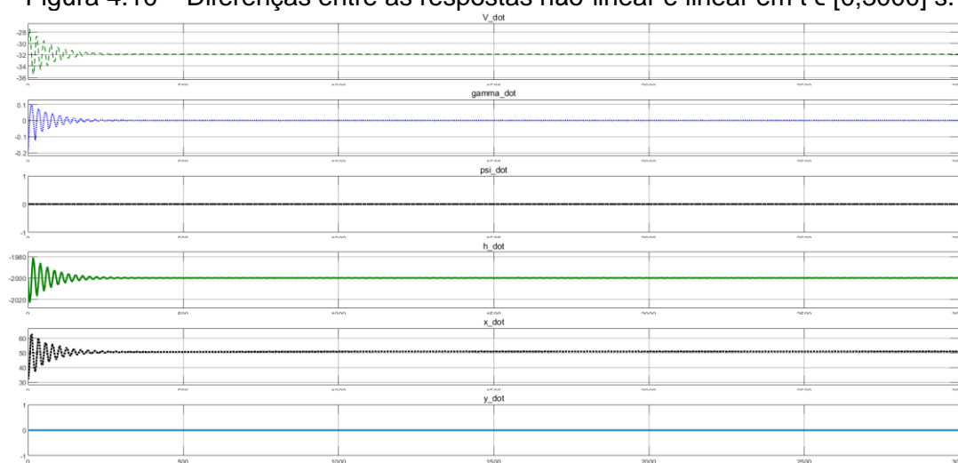
Figura 4.10 – Diferenças entre as respostas não-linear e linear em t \in [0;3000] s.
