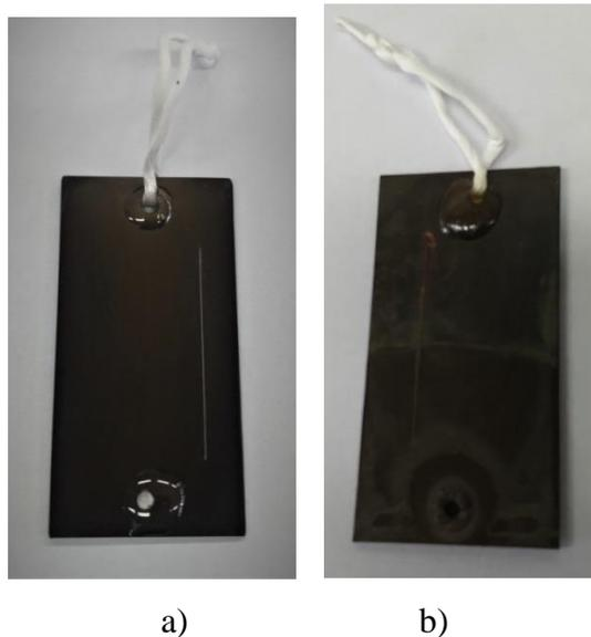
a) antes do ensaio; b) após ensaio de imersão
