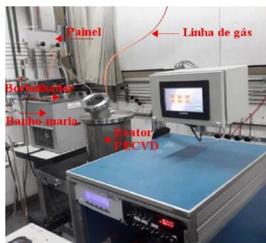
Fig. 2 – Sistema experimental usado para o crescimento de filmes de DLC dopados com boro
