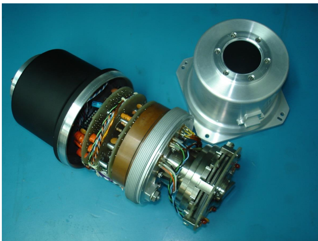
Figura 12 – Sensor de Horizonte do SSR-1
