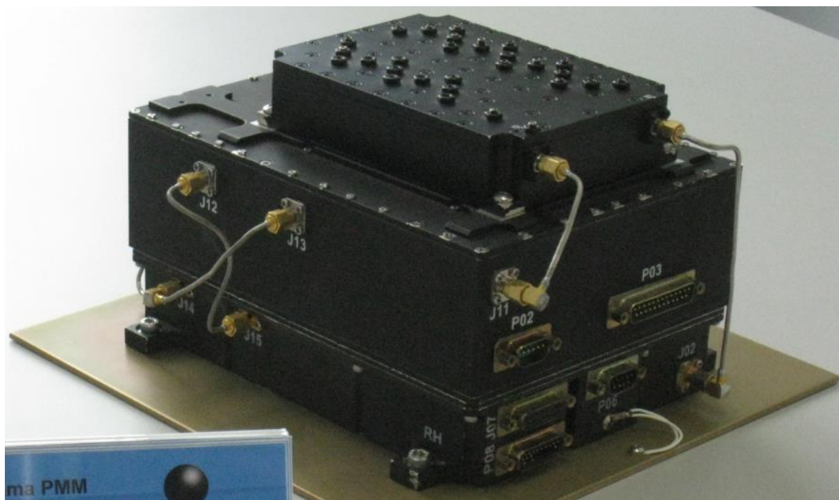
Figura 60 – Transponder em Banda S do TT&C do Amazonia-1
