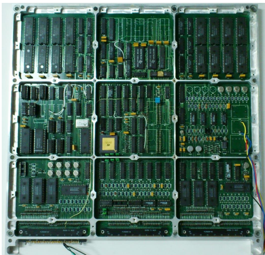
Figura 36 – Modelo de Engenharia de Frame do OBC do SACI
