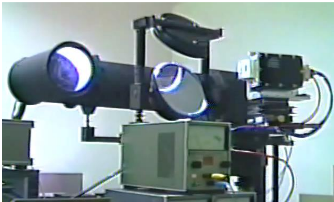
Figura 11 – Modelo de Voo do Sensor Solar Digital do SCD-1 em testes com o Simulador Solar
