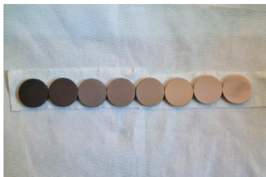
Figura 3 – Progressão de cores em peças anodizadas em diferentes temperaturas.
