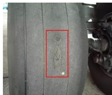
Fig. 3 - Primeira camada de lona exposta.
