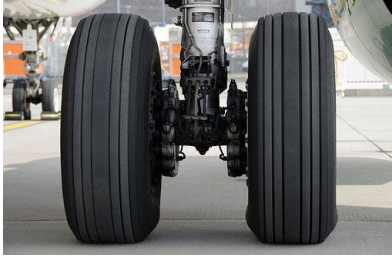
Fig. 4. Desgaste heterogêneo de pneus em um mesmo trem de pouso.
