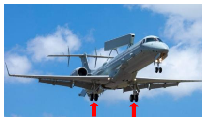
Fig. 1. Disposição dos pneus nos trens de pouso principais.
