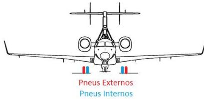
Fig. 5. Posição dos pneus em relação ao trem de pouso principal.
