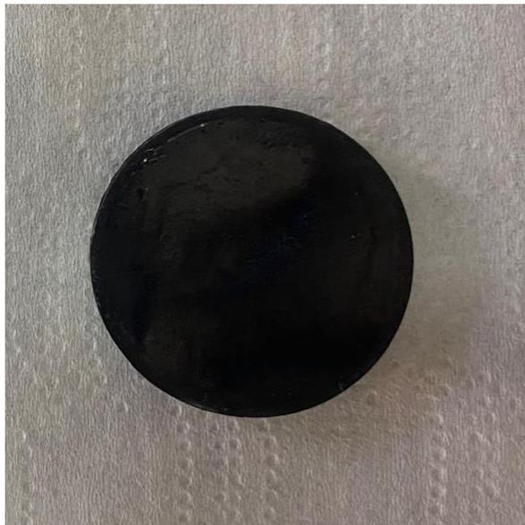
*Figura 9 – ABS após a primeira camada metálica*
