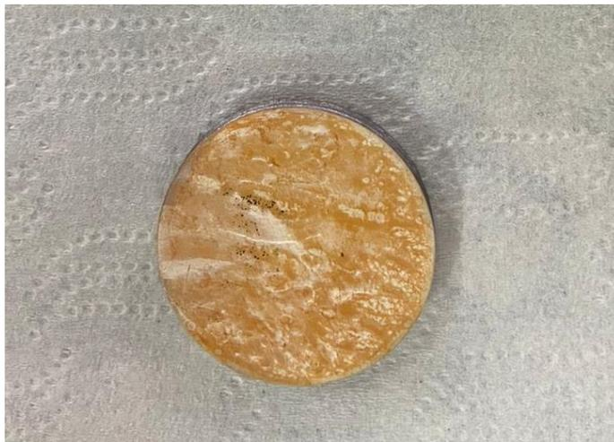
*Figura 8 – ABS após condicionamento e ativação do paládio*
