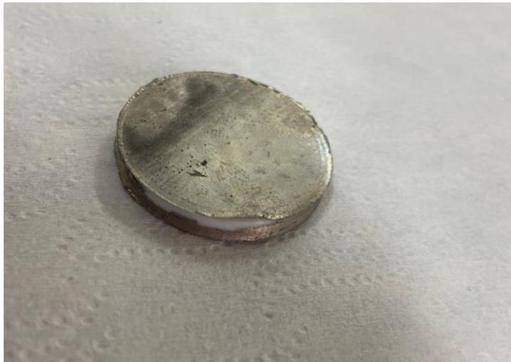
*Figura 7 – ABS metalizado sem a etapa de condicionamento*
