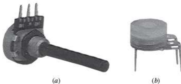
Figura 15 – Resistores variáveis: composto (a); potenciômetro com contato deslizante (b). Figura extraída de [24].
