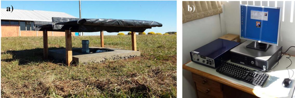
Figura 6.8 - Fotografias do (a) sensor magnético enterrado a aproximadamente 80 centímetros abaixo da superfície e envolto por uma cobertura de madeira e (b) sistema de controle do magnetômetro da estação magnética de São Martinho da Serra (SMS).
