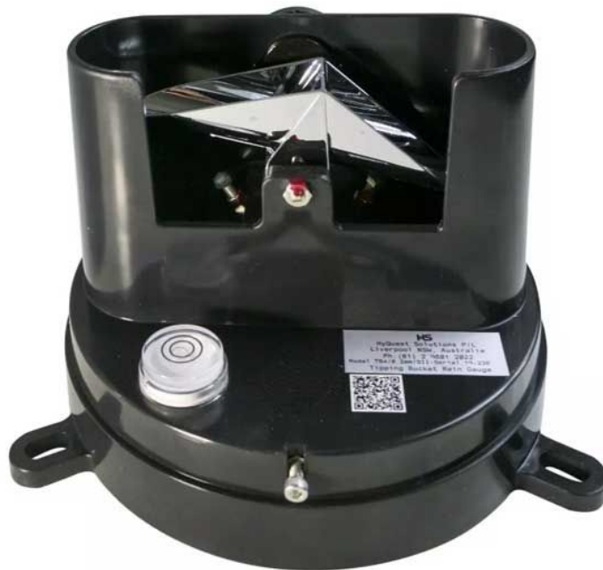
Figura 2.7 - Mecanismo basculante do pluviômetro
