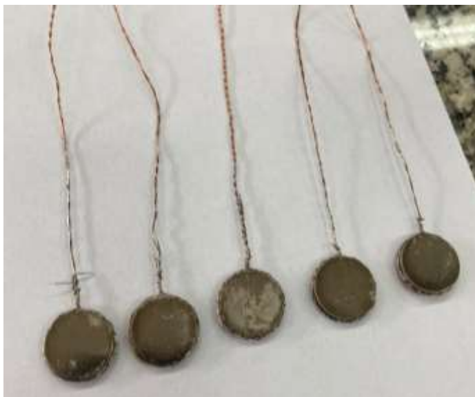
Figura 20: Depósito irregular de NiP obtido no pH = 4,5.
