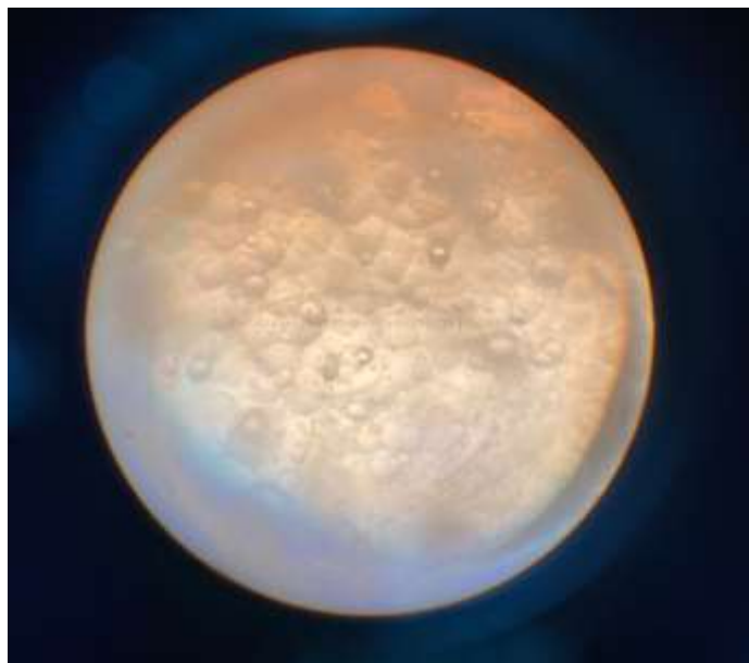
Figura 19: Imagem obtida pelo Esteroscópio do filme de NiP obtido em pH = 4.
