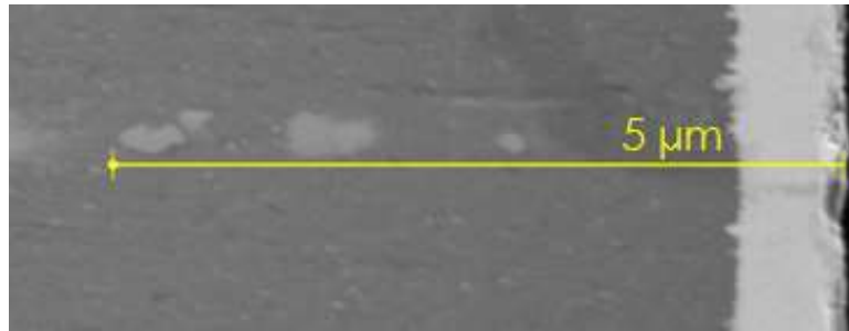
Figura 14: Espessura da camada de NiP depositada no Experimento III.
